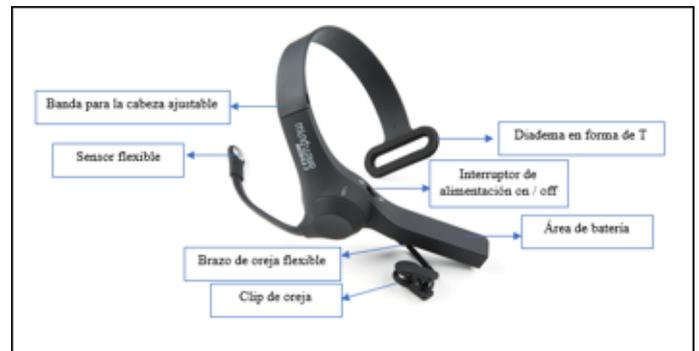
Figura. 4.2. Elementos de Mindwave Mobile 2. [Autor]
