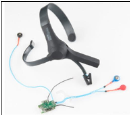
Figura. 4.3. Partes internas de Mindwave Mobile. (Kravitz, 2013)
