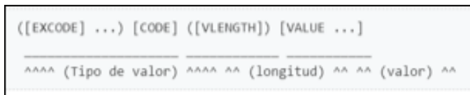
Figura. 1.27. Estructura de DataRow (fila de datos). (Neurosky, Inc, 2017)
