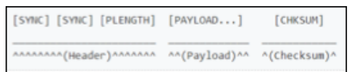
Figura. 5.1. Estructura de paquetes ThinkGear. (Neurosky, Inc, 2017)
